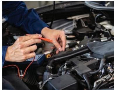
Тестирование энергосистемы для проверки эффективности работы генератора, состояния АКБ и необходимости их обслуживания или замены
